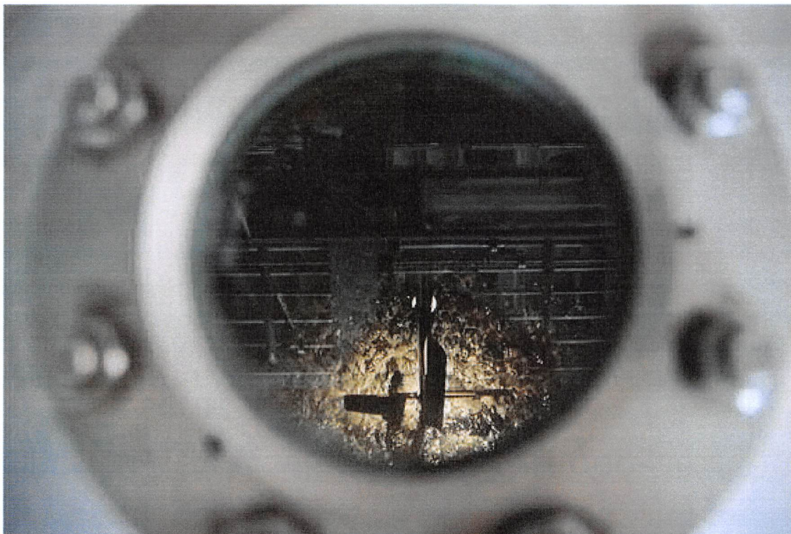
Blick in den Reaktorkessel, in dem ein Bestandteil des flüssigen Kunstharzes gerade gerührt wird.
